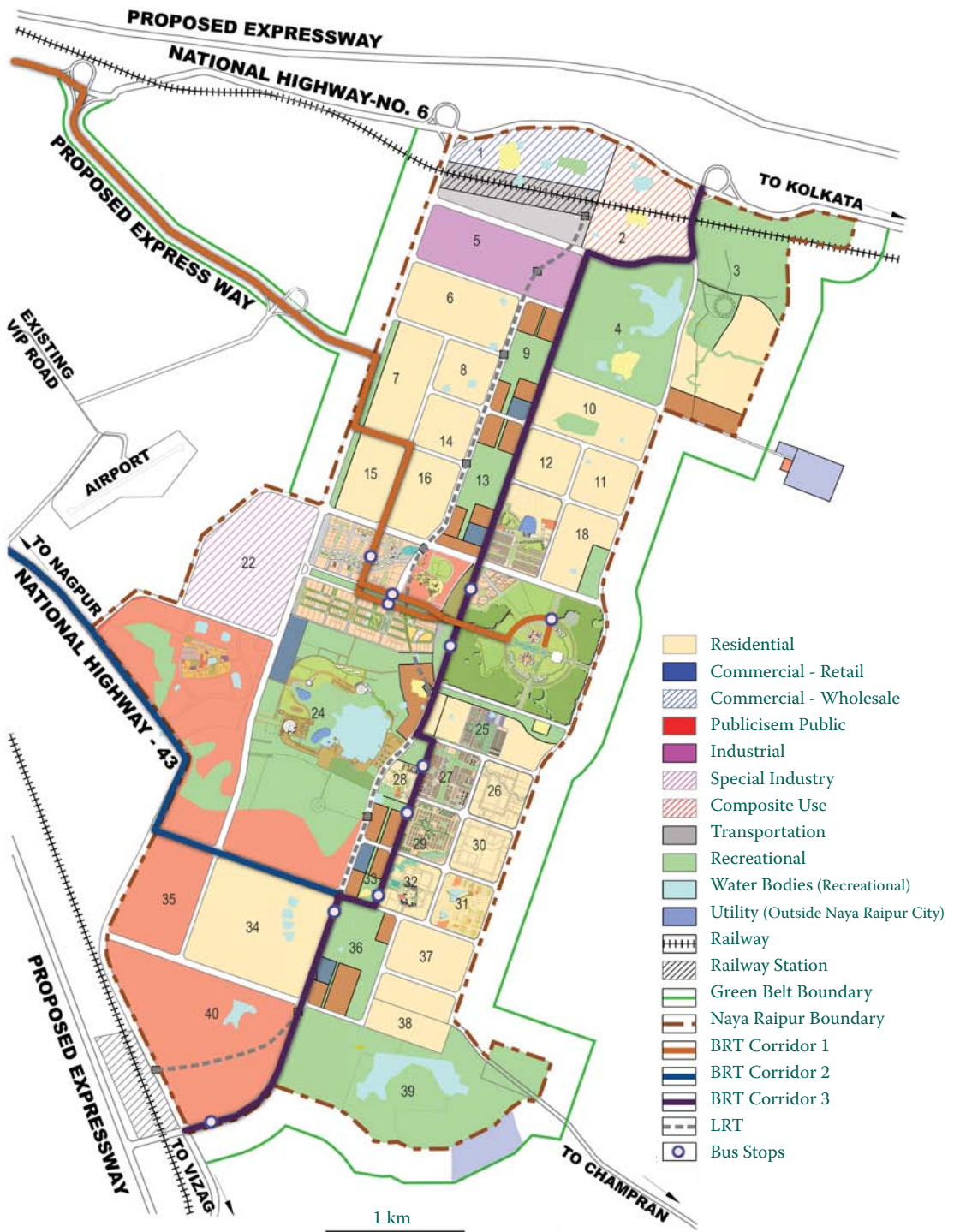
Plan directeur de NRDA montrant la relation entre les transports publics et le développement précoce de certains quartiers dans le cadre d'une étude Transit-Oriented Development (TOD).
