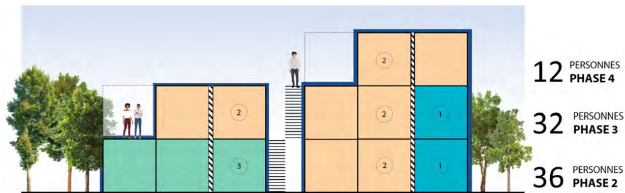
Figure 11: Phasage de l'évolution des bâtiments modulaires "Konstrui deryer", avec la quantité de chambres dans chaque unité et la quantité de nouveaux habitants.
