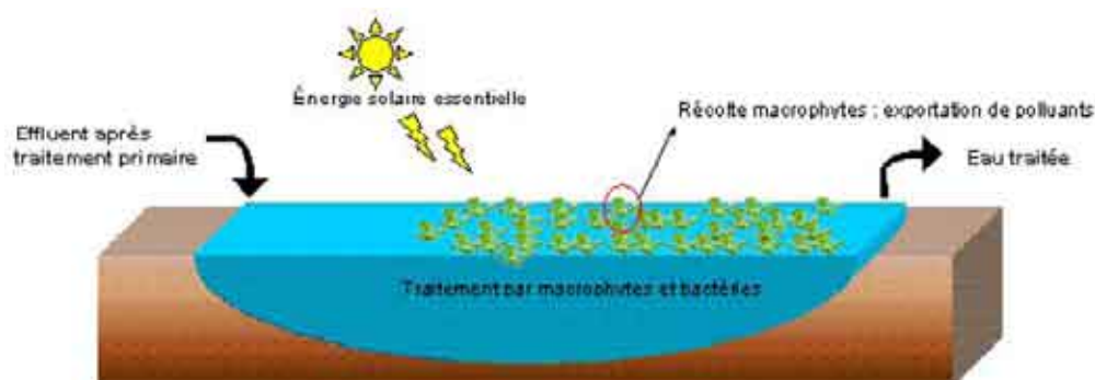
Principe de fonctionnement du lagunage à macrophytes
