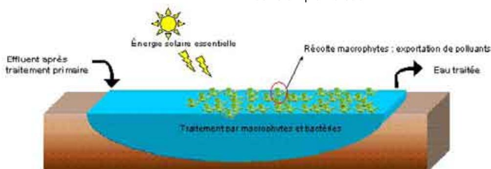
Principe de fonctionnement du lagunage à macrophytes
