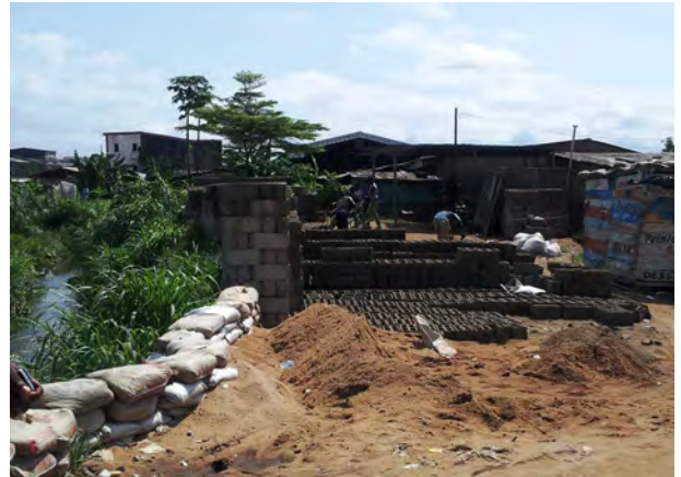
Fabrique de briques entre l'université et CAMTEL : Sac de ciments, sable et eau
