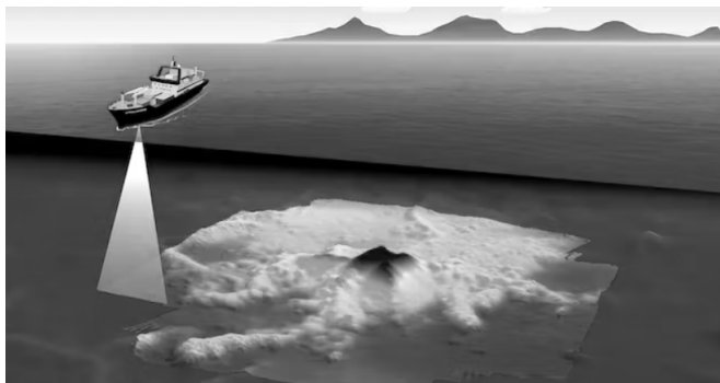
Illustration de l'acquisition bathymétrique au sondeur multifaisceaux par le navire Marion Dufresne II , au-dessus du nouveau volcan (échelles non respectées).
