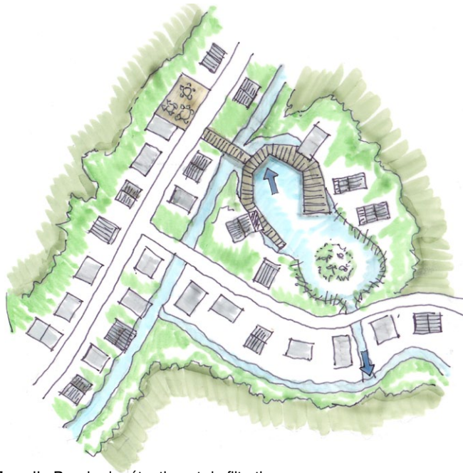
Zone II - Bassin de rétention et de filtration
