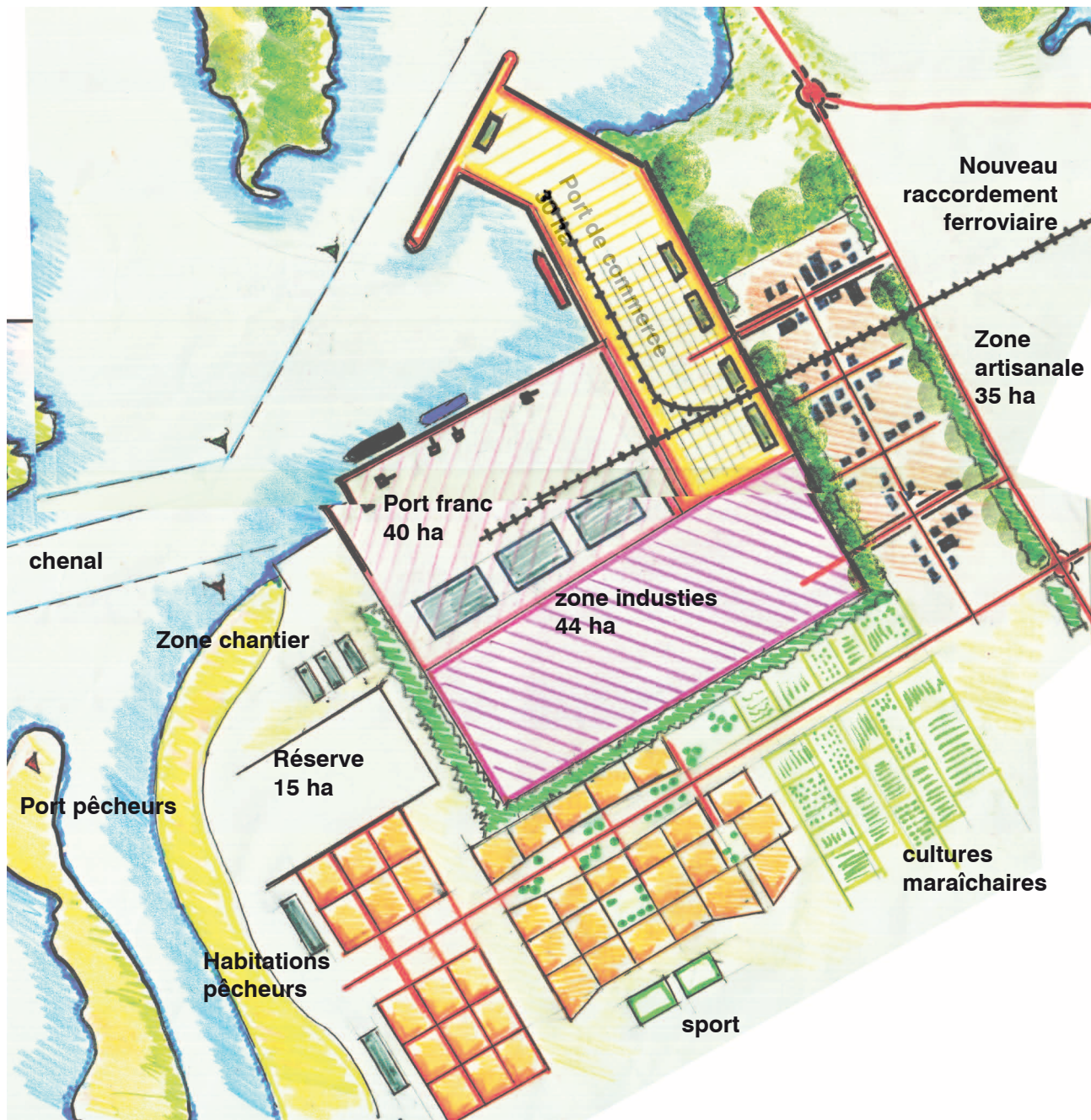
Les différentes zones du triple port - Schéma de principe
